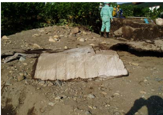
FRPM管破損片
