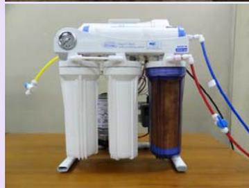
逆浸透膜(左図)により、汲み上げた地下水の淡水化を試験中。
