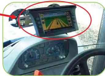
トラクター内のGPSガイダンスのモニター
