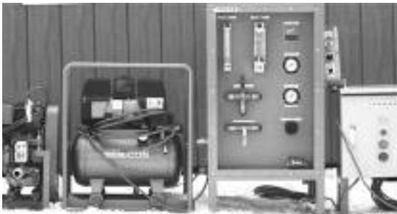
写真 1 懸濁気泡水の発生装置
