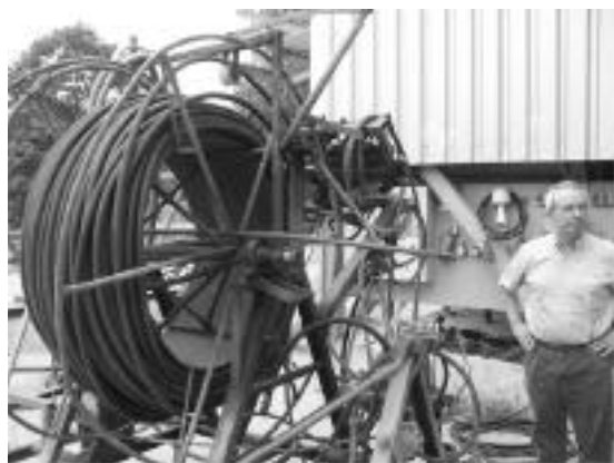
暗渠清掃用機械(先端ノズルからフラッシュする)
