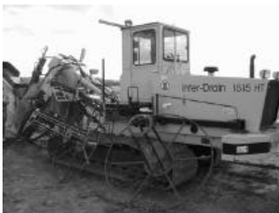
トレンチャー型高速暗渠排水管自動埋設機
