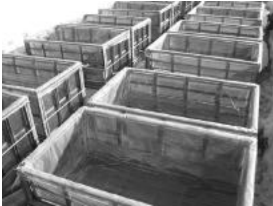
写真4 - スチールコンテナに水深40cm程度給水した状態
