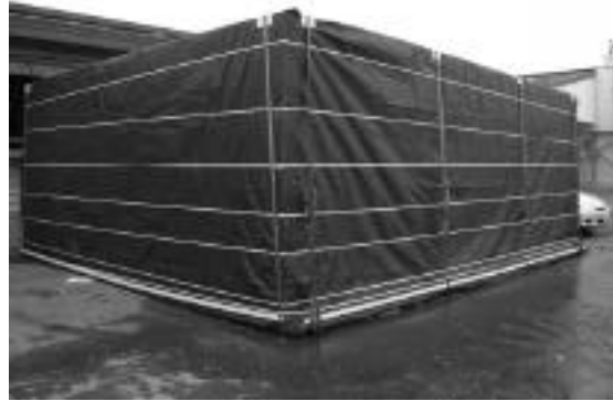
写真6 - 遮光シートで覆った状態の20フィートコンテナ
