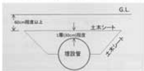
標準的な敷設配置で抵抗土塊が不足する場合の土木シートによる対応断面例
