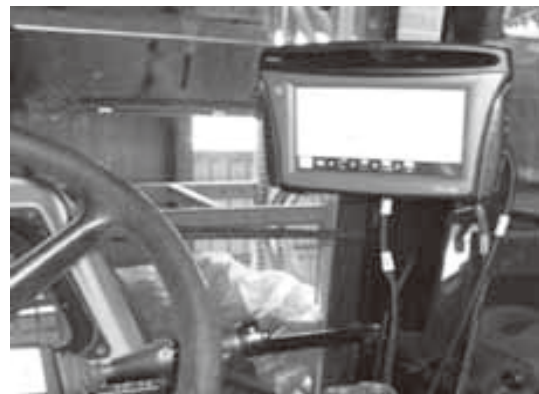
GPSガイダンスシステムを積極的に導入(40台導入)。トラクタ車内に設置されているGPSガイダンスシステム本体。
