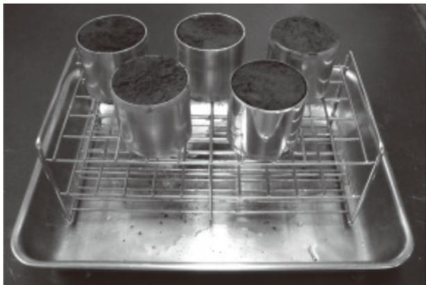
図-16 サンプル試料(重力水の排除)
