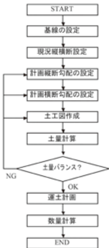
図-3 従来設計手法による設計手順
