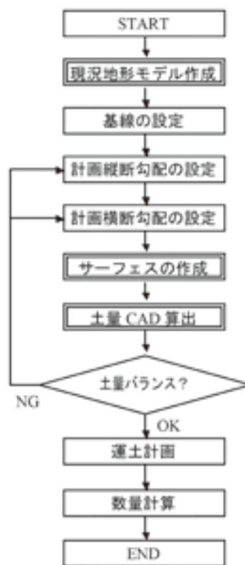
図-4 三次元設計手法による設計手順 (二重線は従来と異なる作業)
