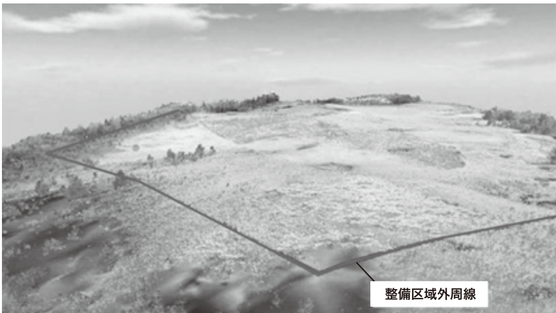
図-5 三次元レーザースキャナーによる点群データ(鳥瞰図)
