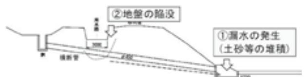
図-2 漏水が発生した場所の断面
