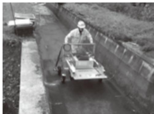
図-13 3Dレーダシステムの測定状況(手押し型)
