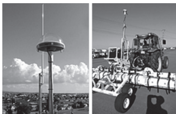
図-10 役場屋上のGPS基地局及びGPSレベラー
