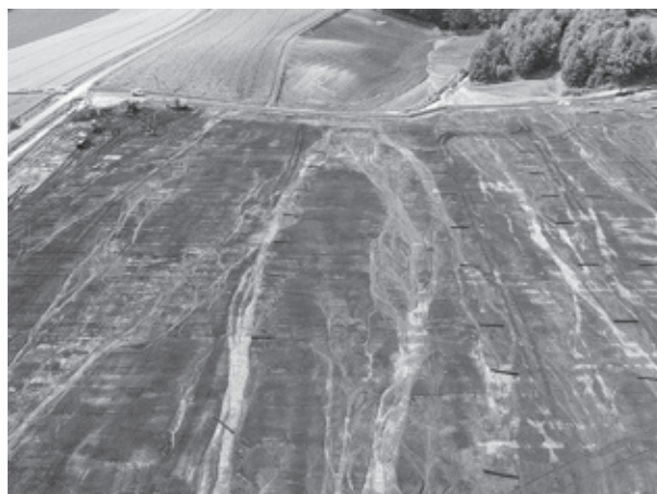
写真-8 降雨による表土流失状況(上空より)
