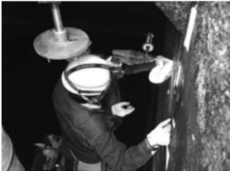
写真-2 コンクリートドリルによる試験状況
