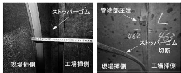
写真-1 継手の拔出し
