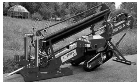
写真-3 誘導式水平ボーリング機(HDD工法)
