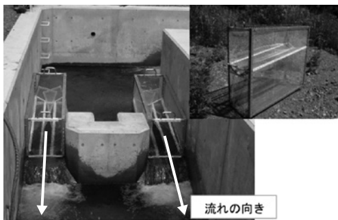
写真-4 かんがい期魚道(アイスハーバー型)に設置した定置網
