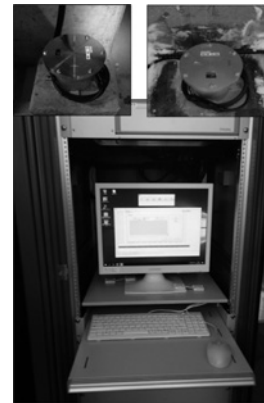
地震観測装置(地震データの自動転送)
