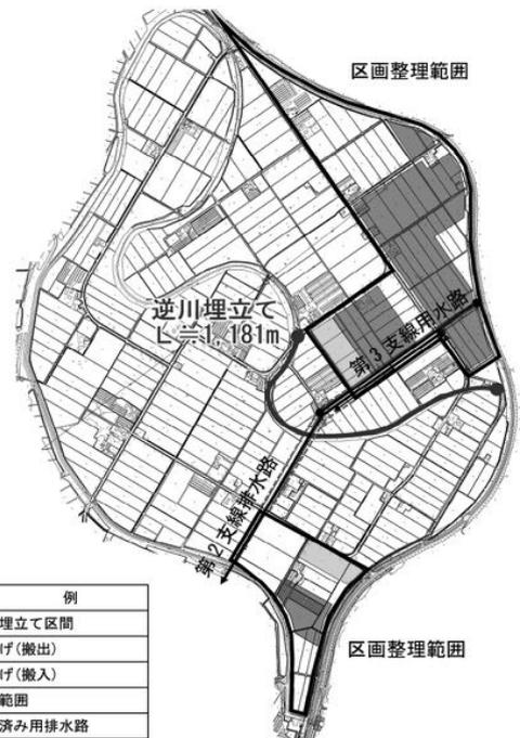
図-10 令和3年度(工事2年目)(逆川埋立て工)
