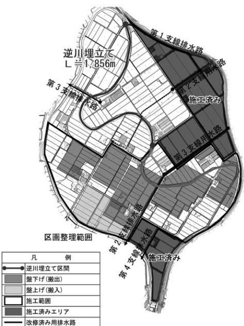
図-13 令和4年度(工事3年目)(逆川埋立て工)
