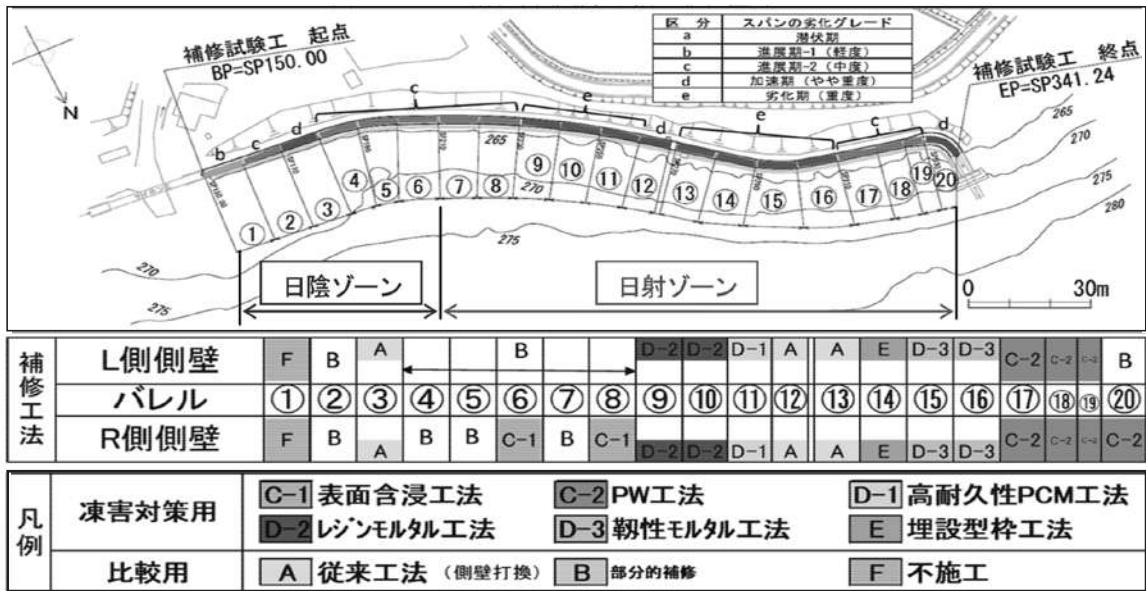
図-2 スパン割り平面図及び対策工法位置図
