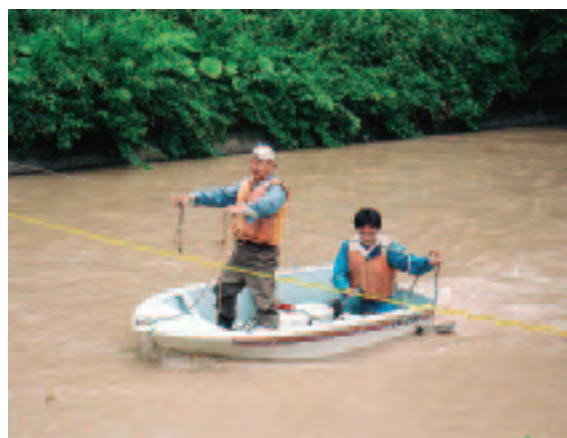
写真－３ ボートによる流量観測事例
