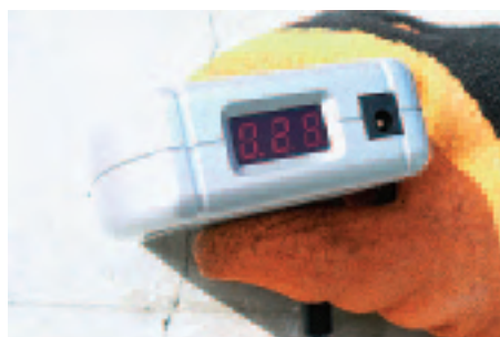
写真-5 ひび割れ幅測定器
