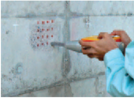
写真-9 テストハンマー打撃状況
