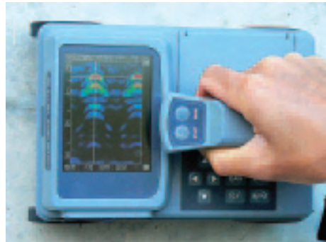
写真-10 電磁波レーダー
