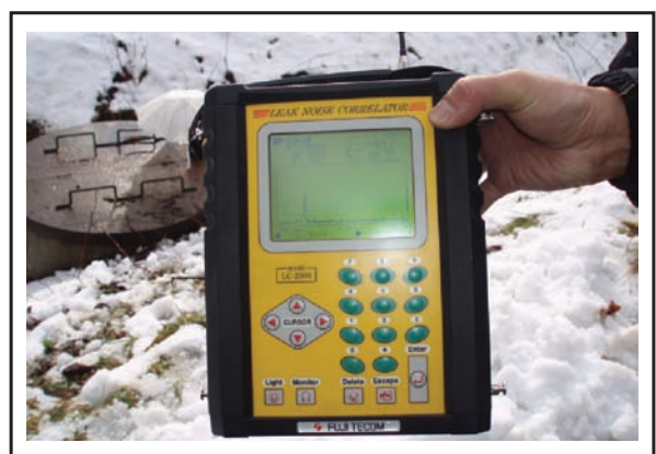
写真-3 装置本体による音圧信号の受信・解析状況
