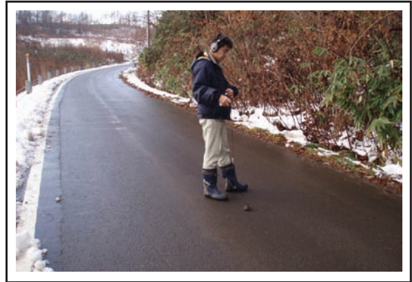
写真－4 漏水探知機による音聴調査状況
