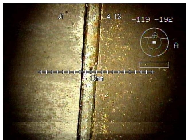
写真-3.5 自走ロボットの目盛表示例
