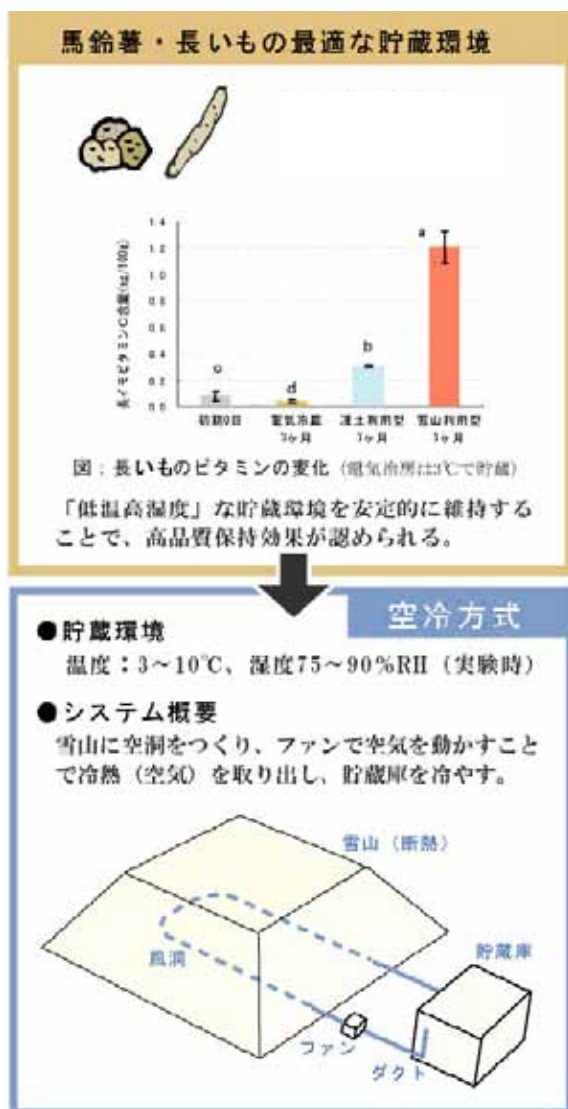
図-18 空冷式貯蔵環境イメージと貯蔵効果
