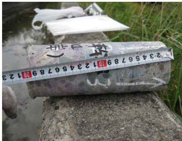
図7 採取コアの表面の状況
