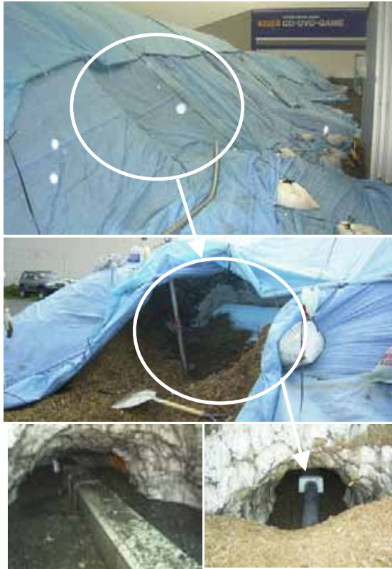
図－8 雪融解箇所の写真 (システムAの配管の雪山貫通箇所)
