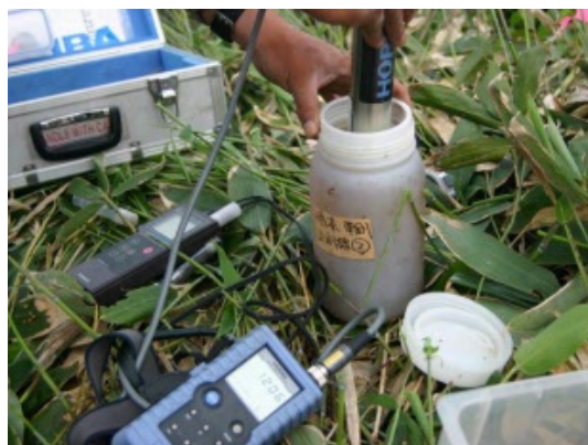
図-8 左：排水路採取状況、上：pH分析、下：DO、EC測定
