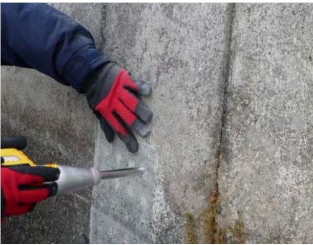
写真-7 コンクリート圧縮強度試験
