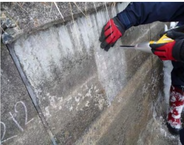
写真-3 コンクリート圧縮強度試験
