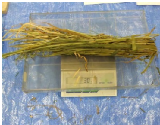
図-14 左：生草重量計測、右：通風乾燥、下：乾物重計測
