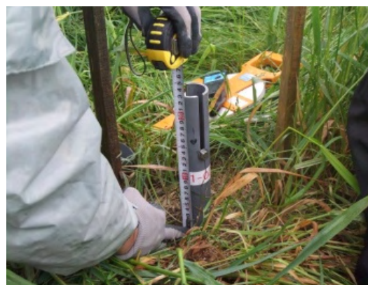
図-4 上：自記記録計回収、中：ミリオン水位計による計測、下：コンベックスによる観測孔計測
