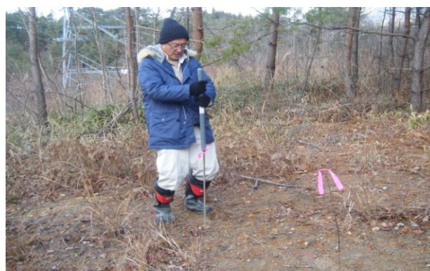
写真－2 ボーリングバーによる掘削
