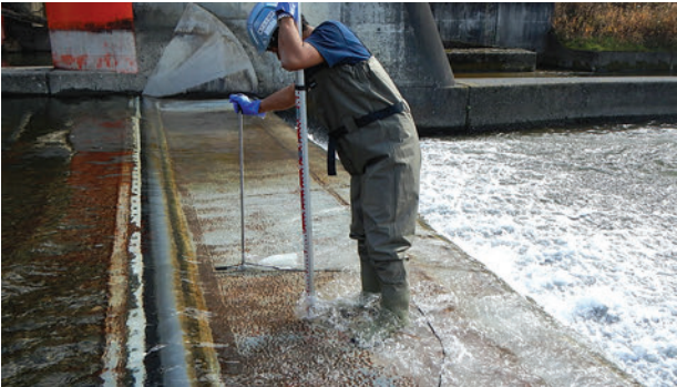
写真－9 流速測定状況
