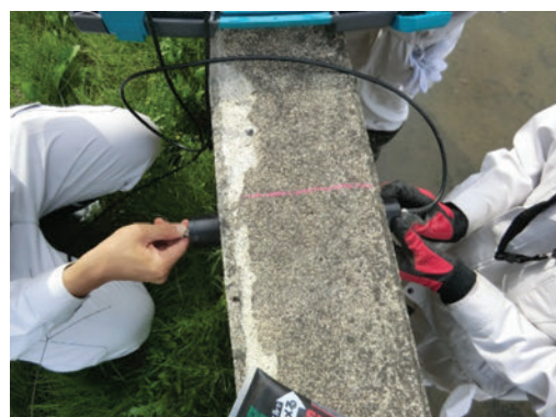
図-8 透過法による測定(超音波伝播速度)
