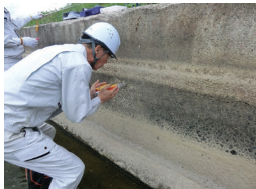
図-7 反発硬度測定(リバウンドハンマー)
