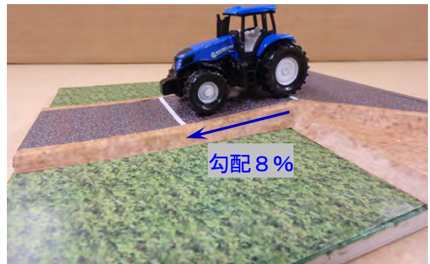
図-17 道路勾配8%モデル(3Dプリンター出力)
