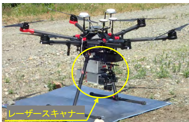
写真-1 レーザースキャナー搭載UAV
