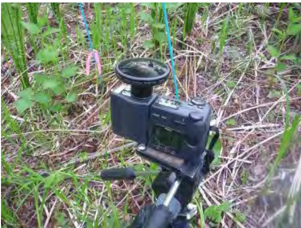
写真－11 全天写真撮影状況
