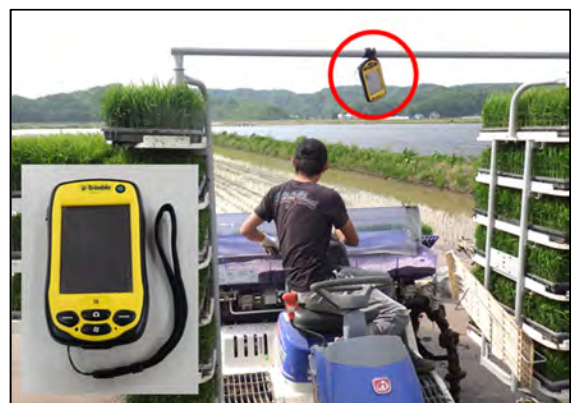
図-5 GPSロガーと作業機搭載状況
