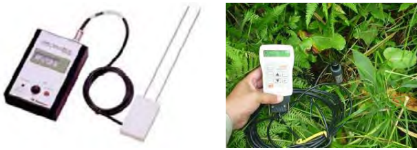
写真－9 土壌水分計及び計測状況
