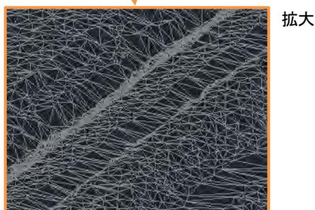
図-9 点群データから作成したTINモデル
