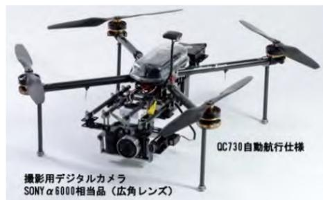
図-3 UAVによる空中写真測量に用いたドローン
