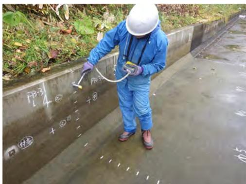
写真-7 機械インピーダンス法計測状況（FB-3）
