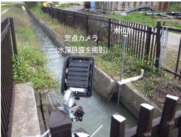
図-15 定点カメラの設置状況
