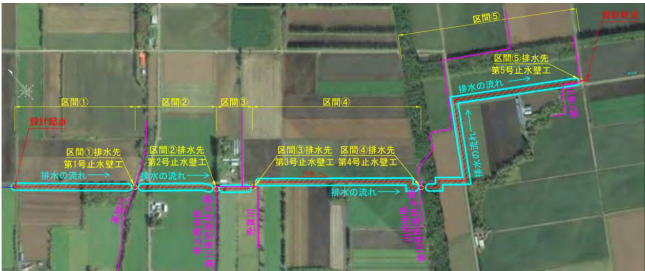
図-9 止水壁とドレーンパイプの配置例（平面図）
