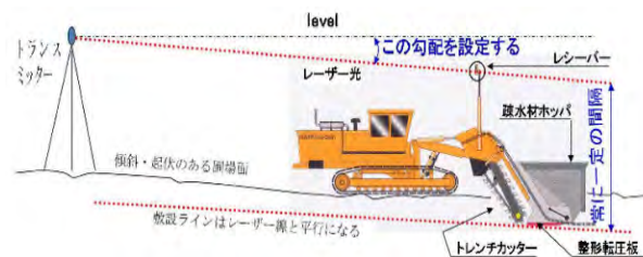
図-3 高速自動埋設機のレーザー制御システムの概要 1)
