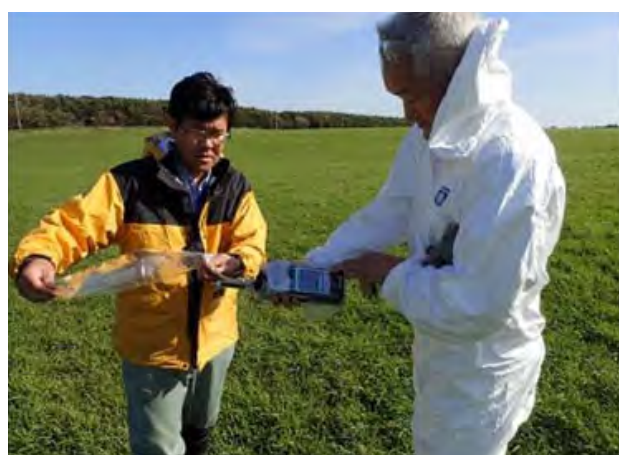
写真－3 臭気センサーでの計測状況
