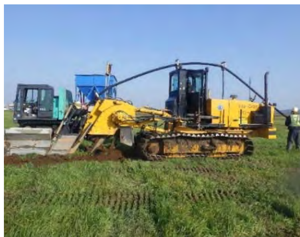
写真-1 高速自動埋設機外観 1)
