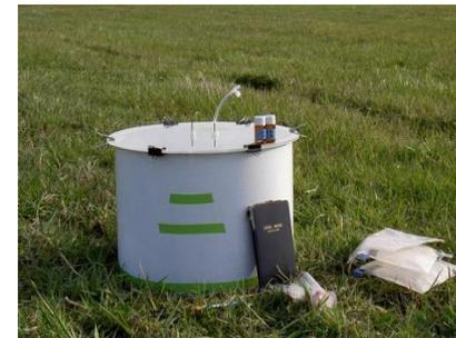
チャンバー法による土壌  $\text{CH}_4$  と  $\text{N}_2\text{O}$  フラックスの測定
