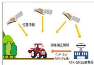
農業機械の自動走行に必要なRTK-GNSS基準局<sup>※</sup>の設置
