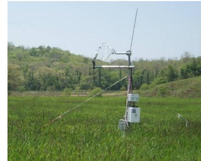
渦相関法を用いた純生態系生産量 (NEP) の測定
