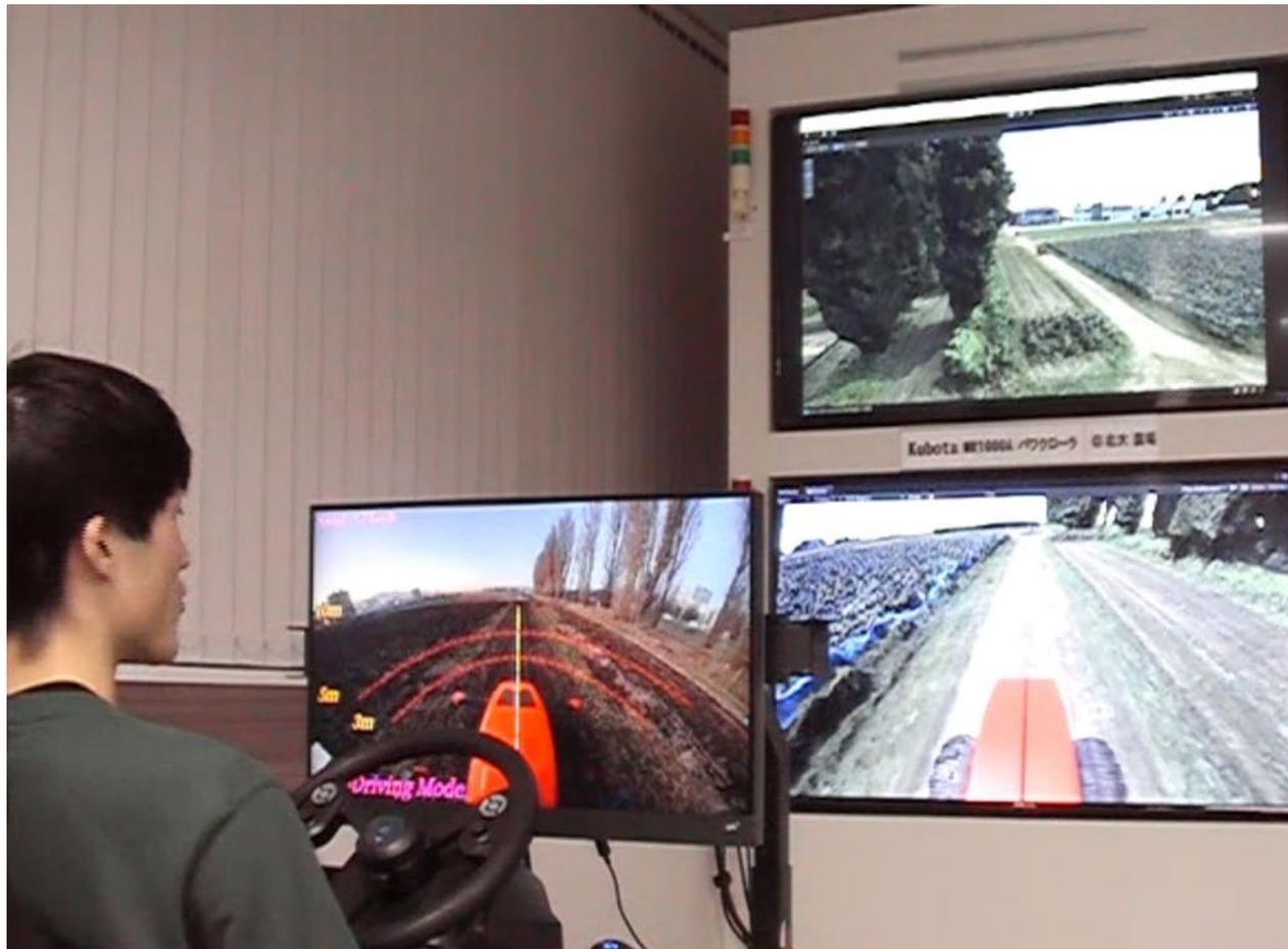
2台のロボット農機を監視・操作するオペレータ
