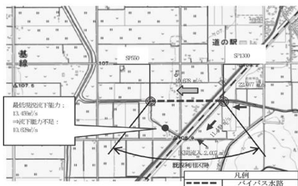
図-9 バイパス水路概要図
