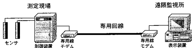
(a) 専用回線を利用したオンライン計測システム
